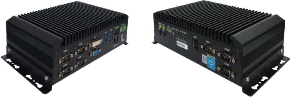
BPC4501, 该产品设计采用Intel第四代Haswell酷睿U系列高性能处理器, SODIMM DDR3低电压内存, 集成Intel HD Graphics 系列显卡, 性能卓越; 具备丰富的I/O资源; 机身采用型材铝鳍结构, 无风扇设计, 具备高可靠性; 是一款专为工业高端应用打造的嵌入式工业计算机。
