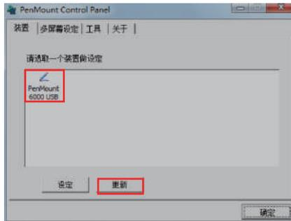
第三步：选中
